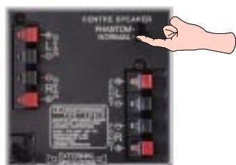
Hvis eksterne fremre høyttalere (venstre og høyre) ikke er tilkoblet, må du kontrollere at Normal/Phantom-bryteren bak på TV-en står på Phantom. Venstre-, høyre- og midtre informasjon vil nå bli gjengitt i TV-høyttalerene.
