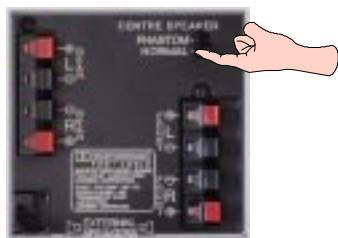
Om externa framhögtalare (vänster och höger) inte är anslutna ska du kontrollera att Normal/Phantom-kontakten bak på TV:n står på Phantom. Vänster-, höger- och centerinformation kommer nu att återges i TV:ns högtalare.
