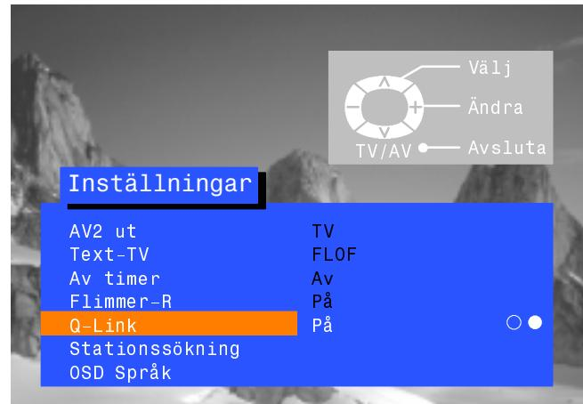
Videon måste vara ansluten till TV mottagarens AV2-uttag med en SCART kabel. Se videons instruktionsbok för vidare information. Q-Link, NEXTVIEWLINK och liknande teknik gör det möjligt för TV:n att skicka kommandon till kompatibla videor så att det program som visas i TV:n kan spelas in, oberoende av kanalinställningarna i videon. Detta gör det enklare att spela in program.
