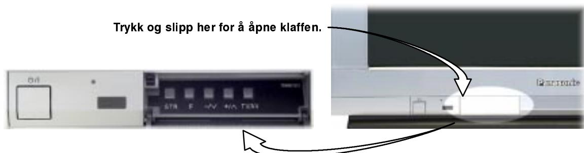
Trykk på F-knappen gjentatte ganger inntil innstillingen for Geomagnetisk korrektsjon vises.
