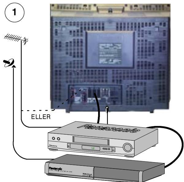
Sätt i antennen och anslut den utrustning som hör till.
